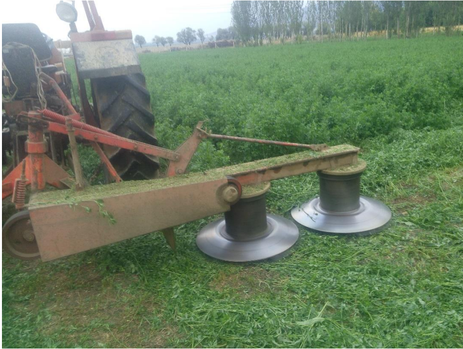
Şekil 4.1. Tamburlu çayır ot biçme makinesi
