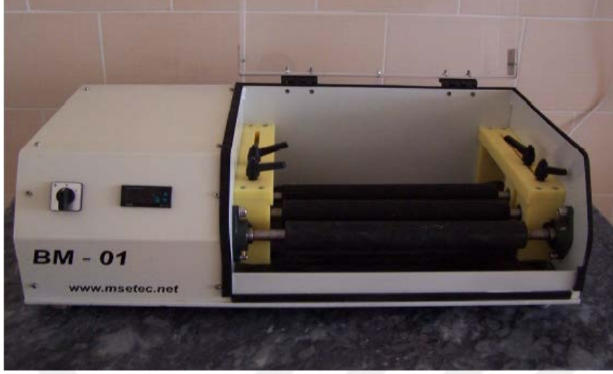
Resim 3.1 MSE-BM/01 markalı bilyeli yatay değirmen.
