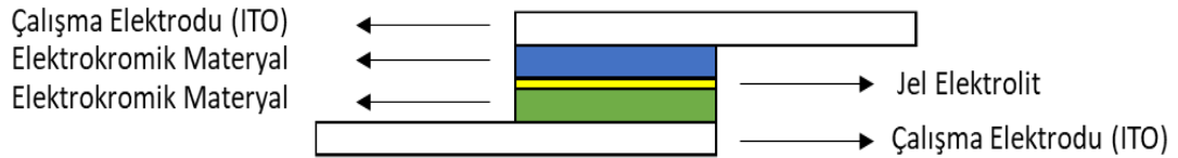
Şekil 2.7: Elektrokromik cihaz kurulumunun basit gösterimi
