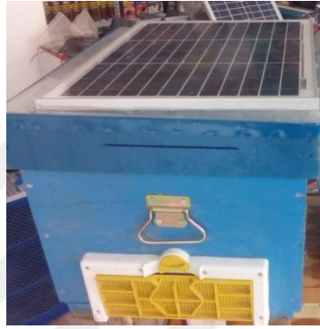
Şekil 3.9. Güneş paneli monte edilmiş arı kovanı
