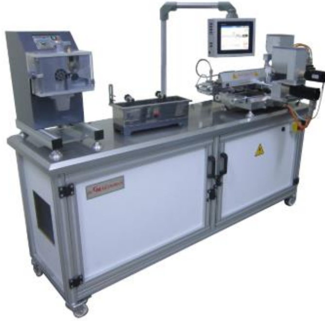
Şekil 6.2. 16 mm Çapında Çift Vidalı Extruder
