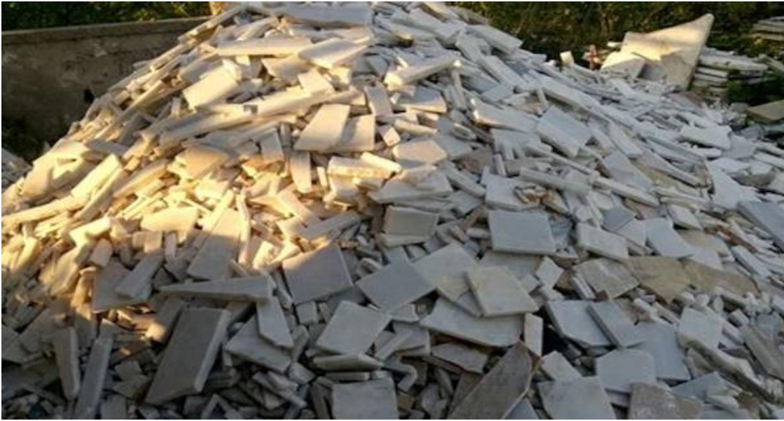
Şekil 2.4. Mermerin fabrikadaki kesiminden sonra oluşan paledyen artık
