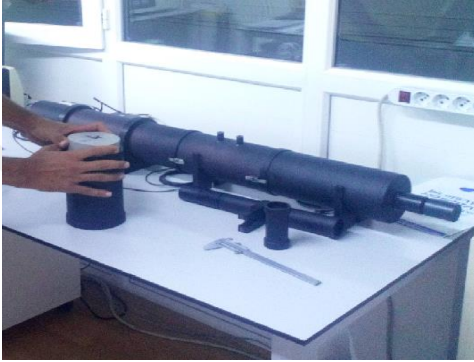
Şekil 3.20. Ses yutum katsayısı ölçüm cihazına malzemelerin yerleştirilmesi
