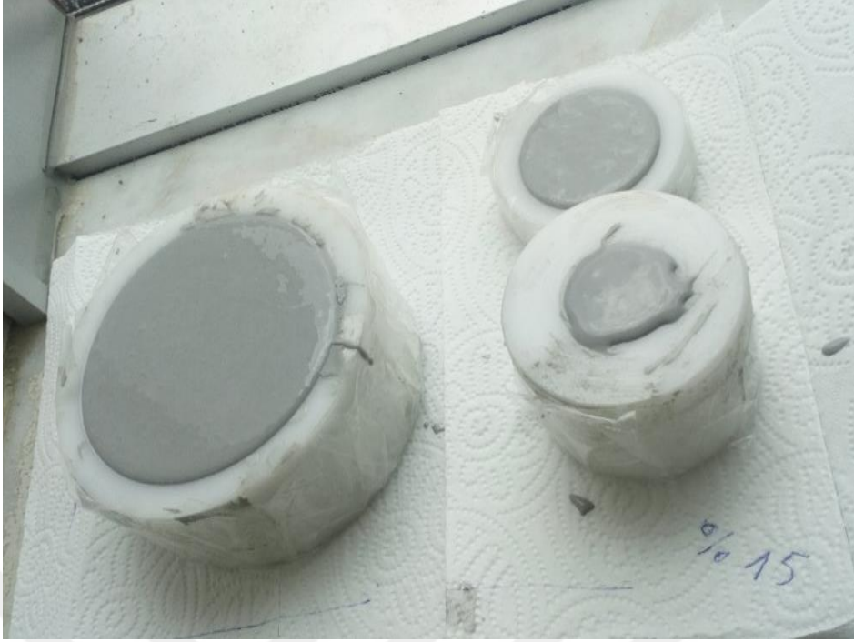
Şekil 3.13. Döküm işleminden sonra kürlenme için bekletilen kalıplar
