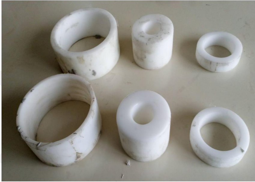
Şekil 3.4. Kompozit malzeme yapımında kullanılan kalıplar
