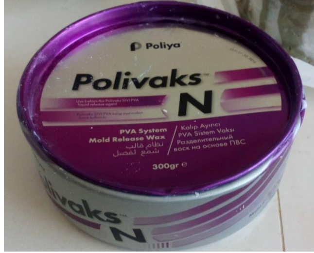
Şekil 3.5. Kalıp ayırma işleminde birinci aşama kalıp ayırıcı Polivaks N
