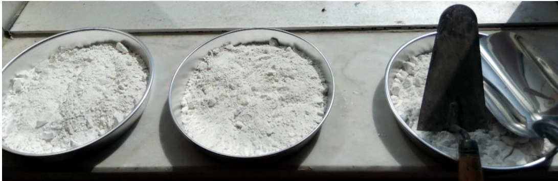
Şekil 3.8. Etüvde 200°C’de kurutulmuş mermer tozu
