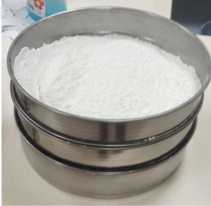
Şekil 3.10. Elek analiz sonucunda 300-355 \mu tane boyutunda mermer tozu
