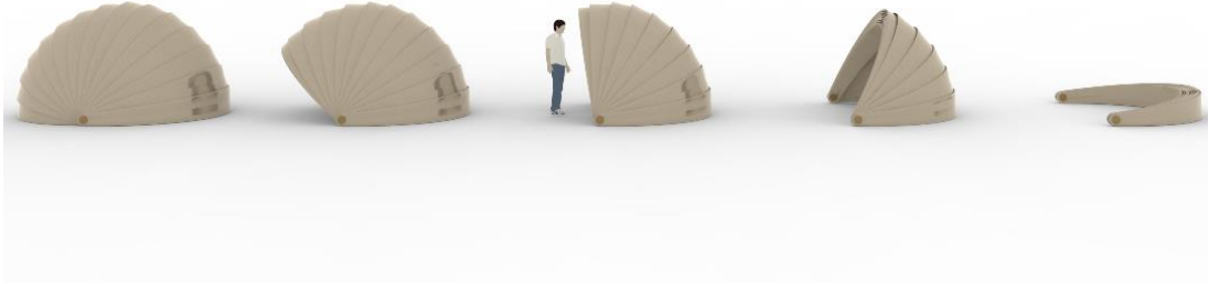
Şekil 4.9. Acil durum barınağının açılıp kapanması
