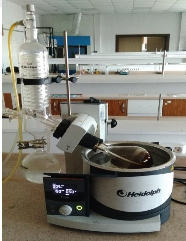
Şekil 3.4 Sıvı Ürününün Çözücüden Ayrılması İşlemi.
