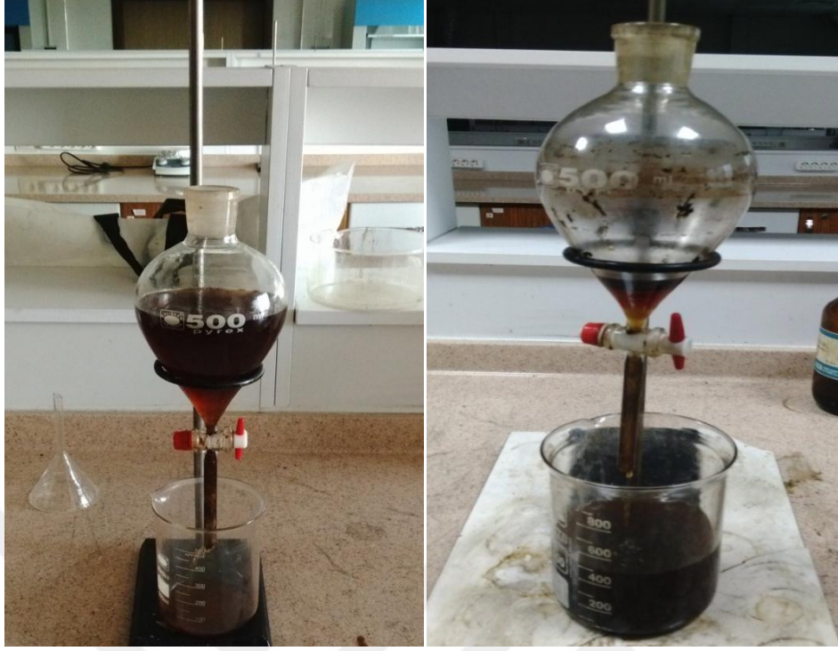
Şekil 3.3 Piroliz Sonrası Sıvı Ürünün Bünyedeki Sudan Ayrılması İşlemi.
