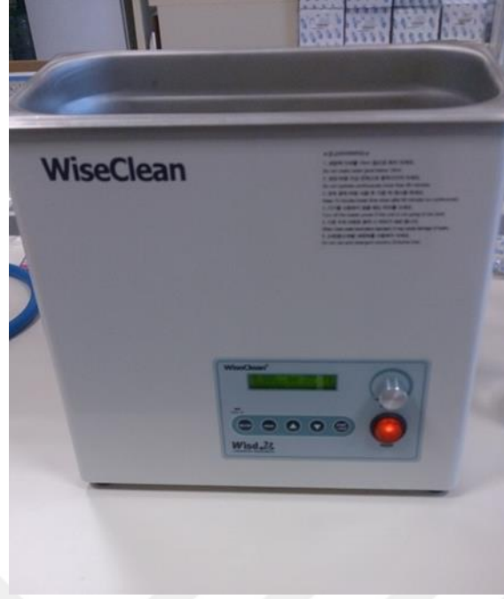
Şekil 2.7. Ultrasonik Su Banyosu
