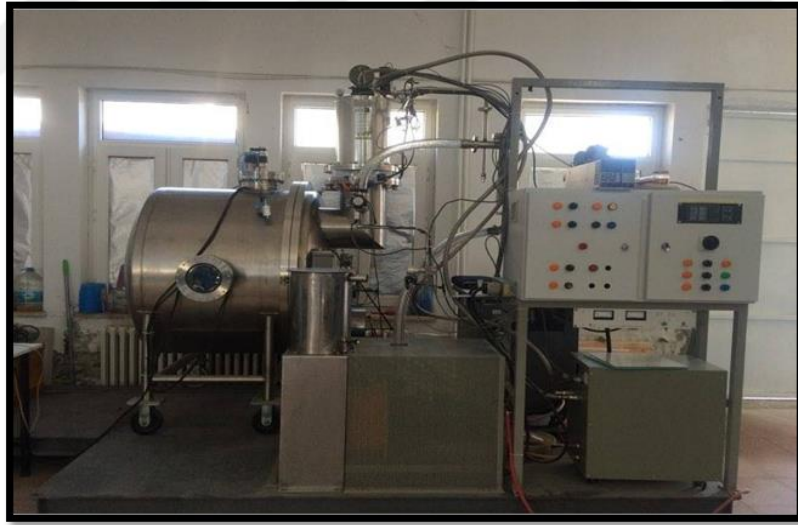
Şekil 3.10. Elektron demeti ile buharlaştırma sisteminin şematik gösterimi
