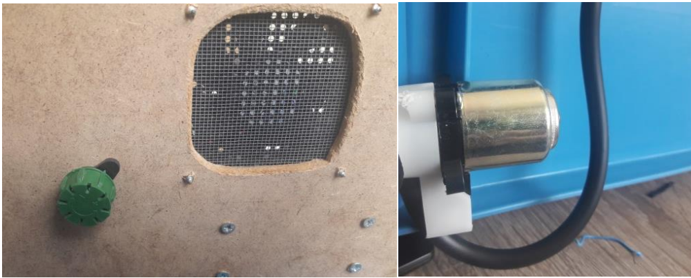
Şekil 3.11. Sistemde kullanılan fiskiye ve su pompası
