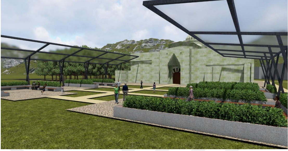
Şekil 5.10. Alternatif 2: Etfе malzemesi ve alüminyum profil kullanılarak oluşturulmuş üst örtü (Modelleme ve Görselleştirme: Bakır D. R.)
