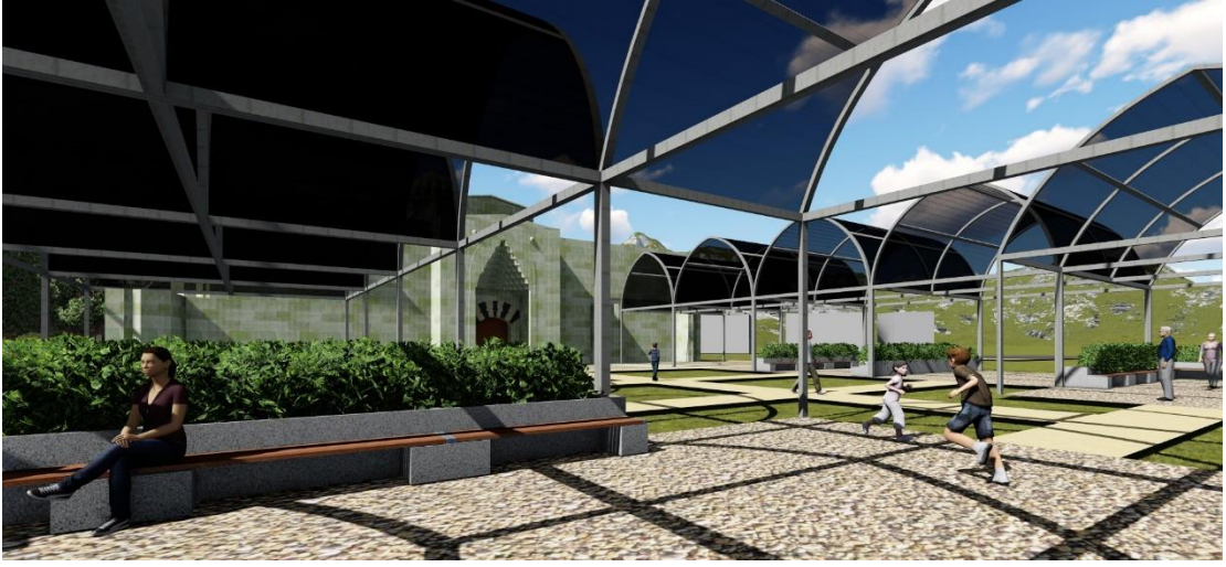
Şekil 5.6. Alternatif 1: Etfе malzemesi ve alüminyum profil kullanılarak oluşturulmuş üst örtü (Modelleme ve Görselleştirme: Bakır D. R.)
