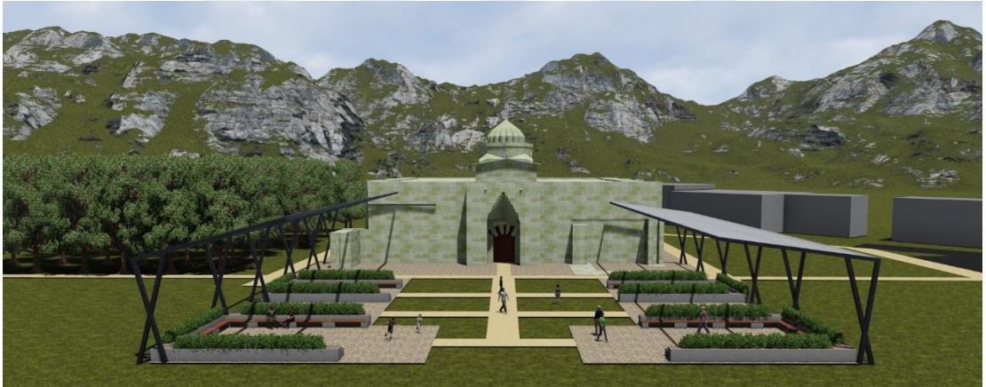
Şekil 5.9. Alternatif 2: Etef malzemesi ve alüminyum profil kullanılarak oluşturulmuş üst örtü (Modelleme ve Görselleştirme: Bakır D. R.)
