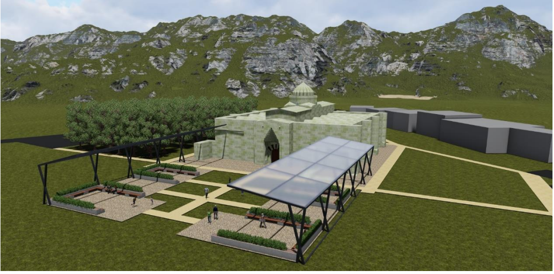
Şekil 5.8. Alternatif 2: Etef malzemesi ve alüminyum profil kullanılarak oluşturulmuş üst örtü (Modelleme ve Görselleştirme: Bakır D. R.)
