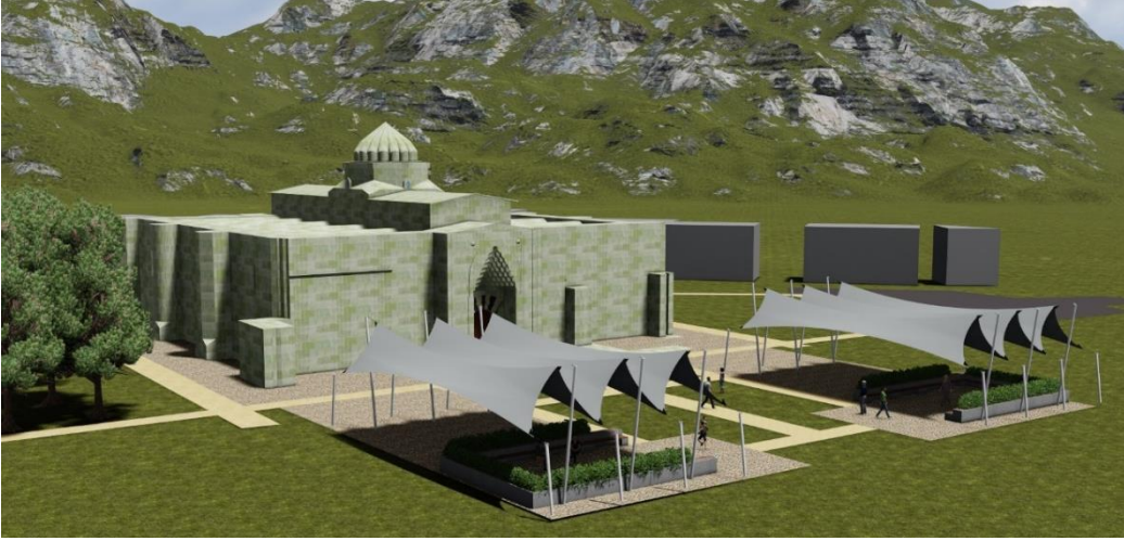
Şekil 5.32. Alternatif 8: Membran malzemesi ve alüminyum profil kullanılarak oluşturulmuş üst örtü (Modelleme ve Görselleştirme: Bakır D. R.)
