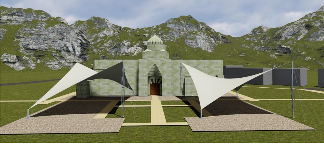
Şekil 5.25. Alternatif 6: Membran malzemesi ve alüminyum profil kullanılarak oluşturulmuş üst örtü (Modelleme ve Görselleştirme: Bakır D. R.)
