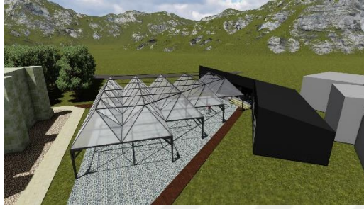
Şekil 5.17. Alternatif 4: Etfе malzemesi ve alüminyum profil kullanılarak oluşturulmuş üst örtü (Modelleme ve Görselleştirme: Bakır D. R.)
