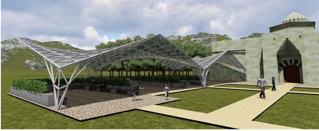
Şekil 5.21. Alternatif 5: Termokromik - elektrokromik tabakalı camlar kullanılarak oluşturulmuş üst örtü (Modelleme ve Görselleştirme: Bakır D. R.)
