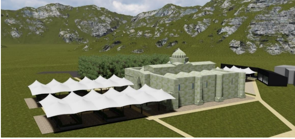
Şekil 5.35. Alternatif 9: Membran malzemesi ve alüminyum profil kullanılarak oluşturulmuş üst örtü (Modelleme ve Görselleştirme: Bakır D. R.)
