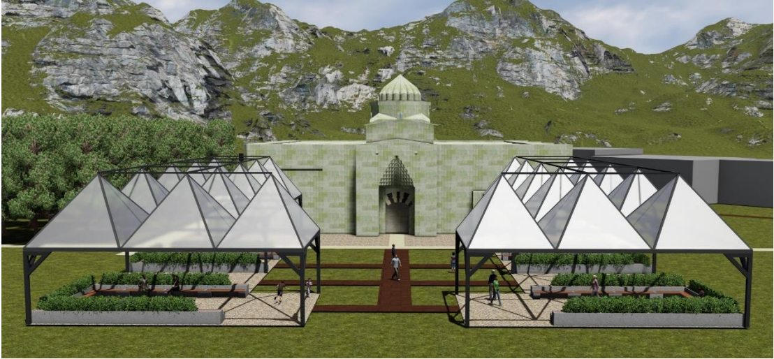
Şekil 5.15. Alternatif 4: Etfе malzemesi ve alüminyum profil kullanılarak oluşturulmuş üst örtü (Modelleme ve Görselleştirme: Bakır D. R.)
