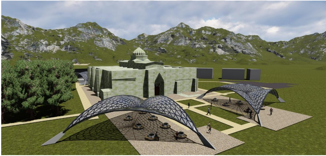
Şekil 5.28. Alternatif 7: Etfel malzemesi ve alüminyum profil kullanılarak oluşturulmuş üst örtü (Modelleme ve Görselleştirme: Bakır D. R.)
