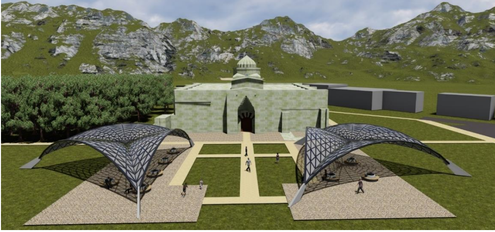
Şekil 5.29. Alternatif 7: Etfе malzemesi ve alüminyum profil kullanılarak oluşturulmuş üst örtü (Modelleme ve Görselleştirme: Bakır D. R.)
