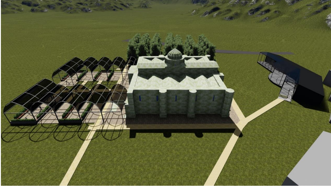
Şekil 5.4. Alternatif 1: Etfе malzemesi ve alüminyum profil kullanılarak oluşturulmuş üst örtü (Modelleme ve Görselleştirme: Bakır D. R.)
