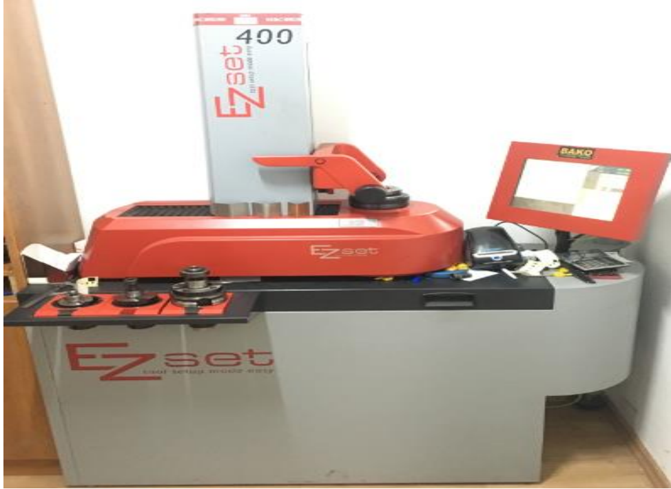
Şekil 3.12. Kesici takım ölçüm cihazı genel görünümü
