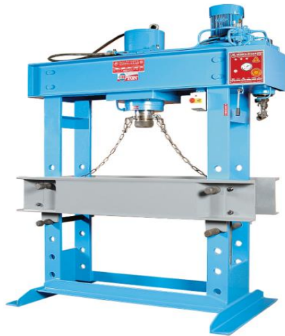
Şekil 3.9. Atölye tipi hidrolik pres
