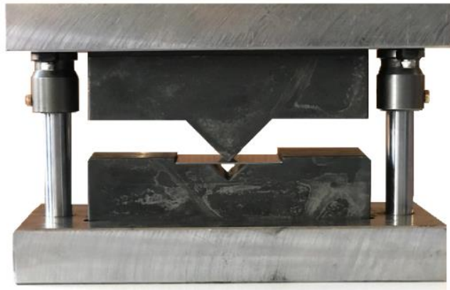
Şekil 3.5. 90° V bükme kalıbı
