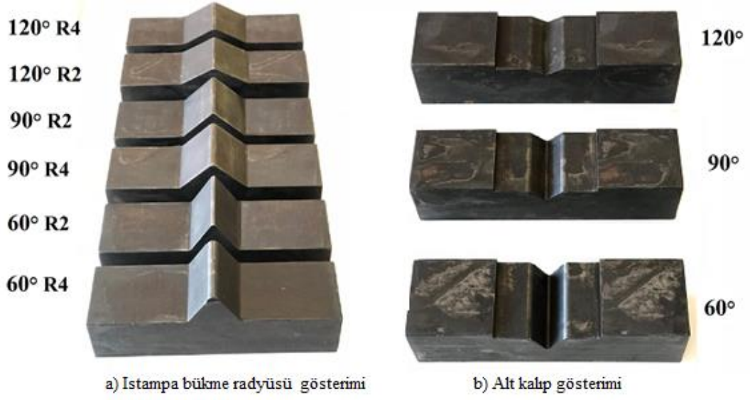
Şekil 3.3. Açılara göre bükme radyüsleri ve alt kalıp gösterimleri
