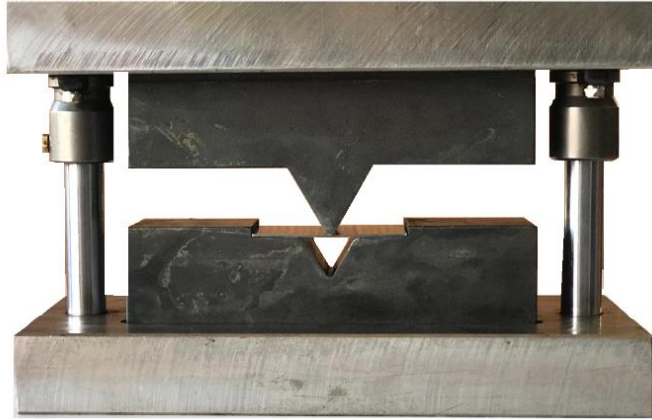
Şekil 3.4. 60° V bükme kalıbı
