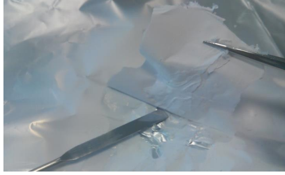
Şekil 3.6. Nanolifin alüminyum folyodan ayrılması
