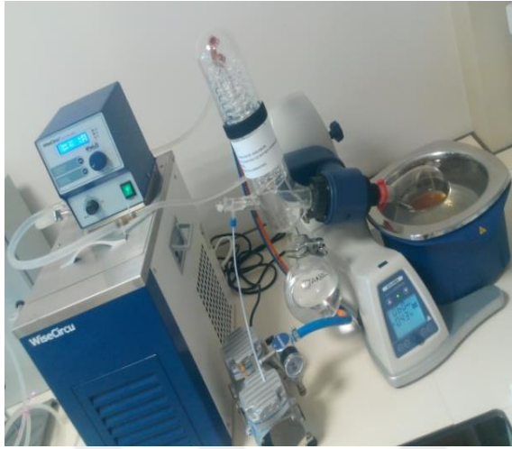
Şekil 3.2. Ekstraktan etanolik fazın uzaklaştırılması
