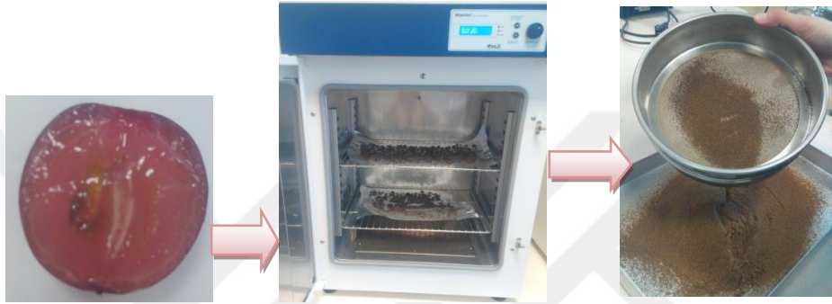
Şekil 3.1. Burdur Dimrit üzüm çekirdeği tozunun hazırlanması
