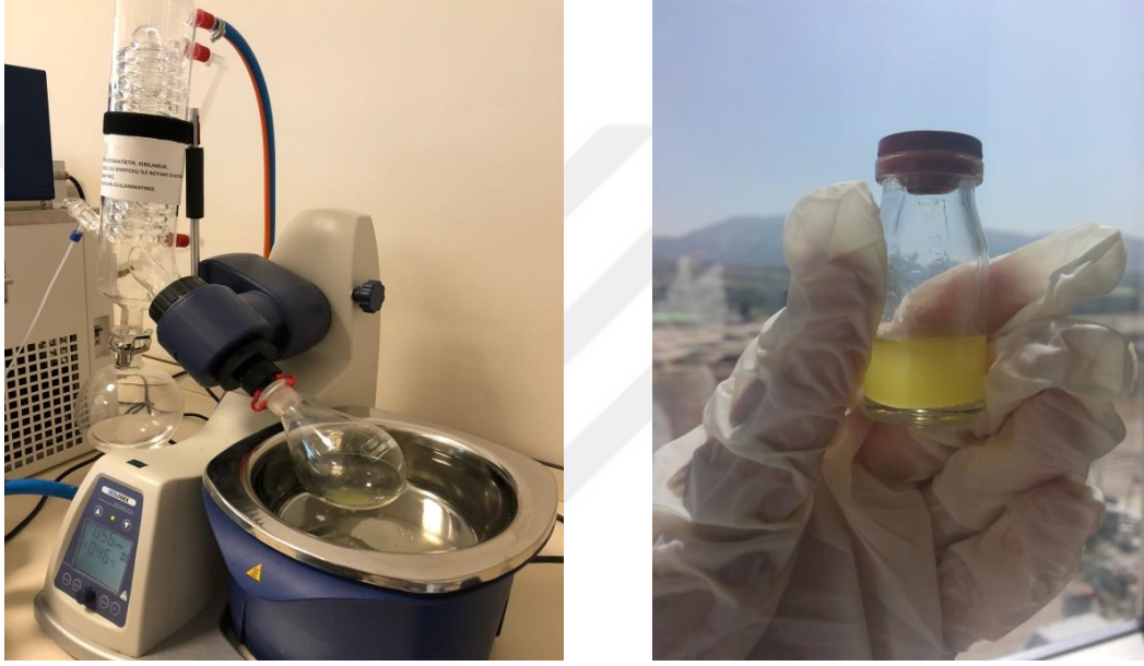
Şekil 3.4. Rotary evaporatör cihazı ve ekstrakt örneği
