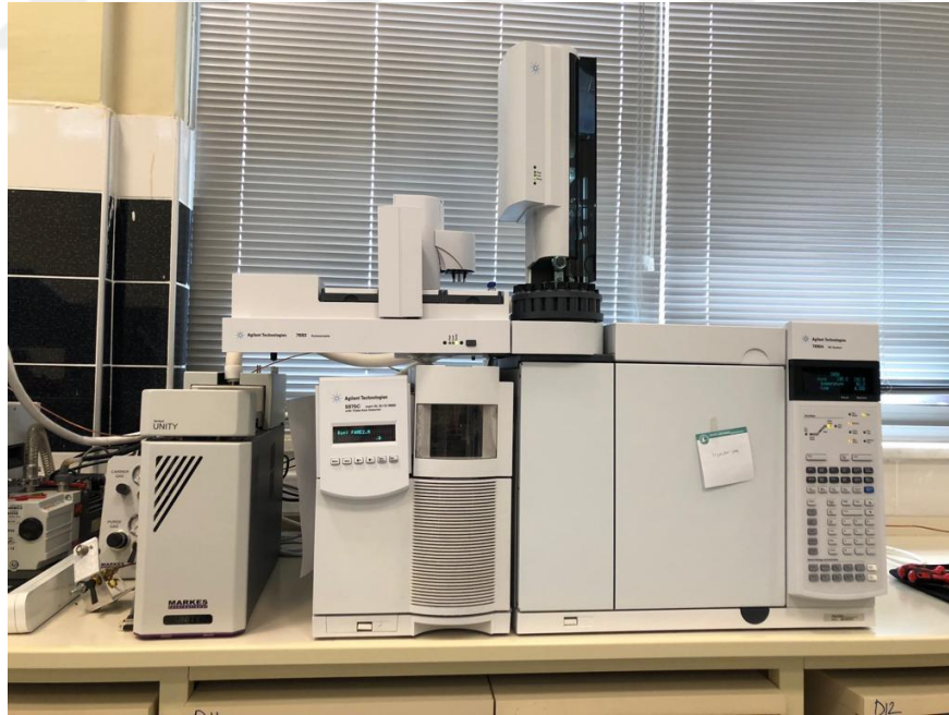
Şekil 3.5. Agilent 7890 A model gaz kromatografi cihazı görüntüsü
