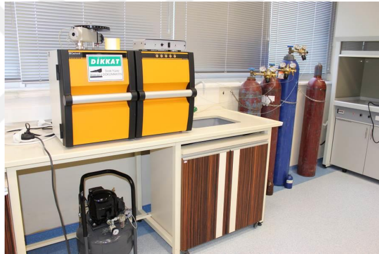
Şekil 3.2. Dumatherm azot tayin cihazı görüntüsü
