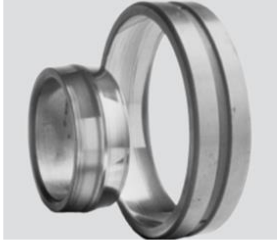
Şekil 2.14. Parlatma aşınması oluşmuş rulman bilezikleri
