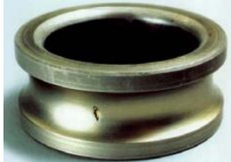
Şekil 2.8. Bilyeli rulman alt yüzey kaynaklı yorgunluk hasarı
