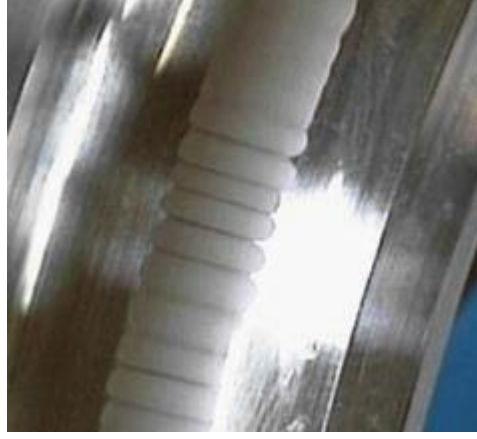
Şekil 2.24. İç bilezikte akım sızma erozyonu izleri
