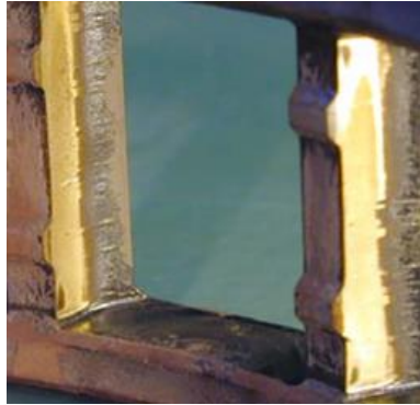
Şekil 2.12. Pirinç kafes içinde cepten aşınma
