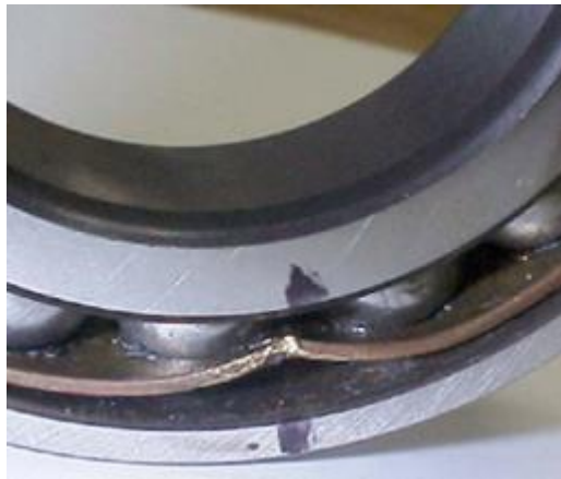
Şekil 2.27. Yanlış taşımadan kaynaklanan kafeste plastik deformasyon
