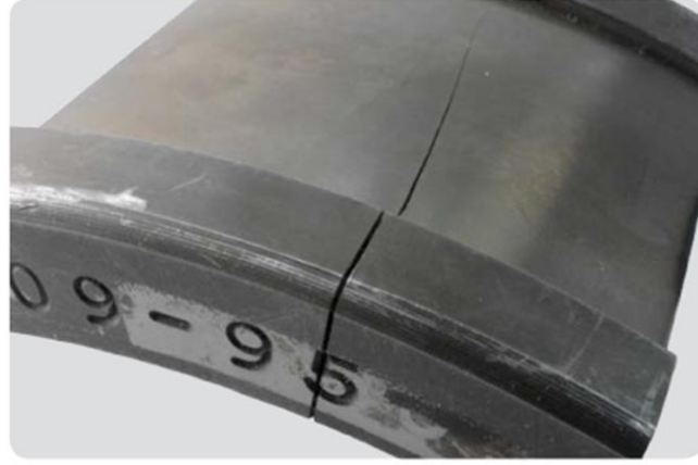
Şekil 2.33. Büyük şaftta montaj sonucu kırılmış silindirik rulman iç bileziği
