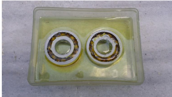
Şekil 3.3. Yapay korozyon oluşumu
