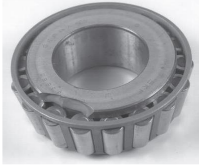
Şekil 2.31. Darbe kaynaklı yüke bağlı kırılma
