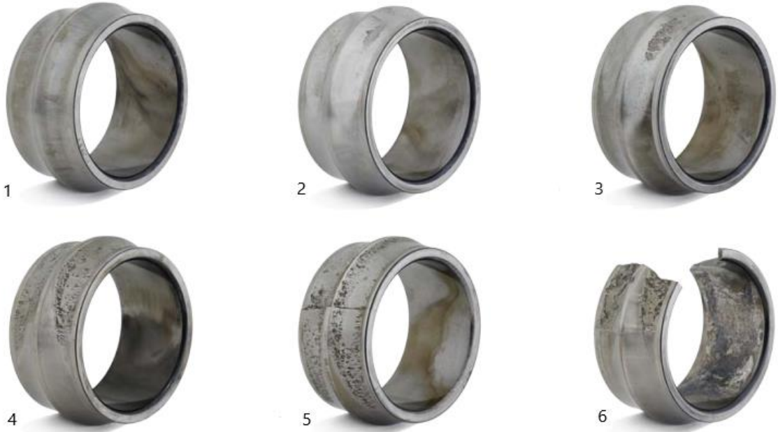
Şekil 2.5. Rulman arıza oluşum süreci
