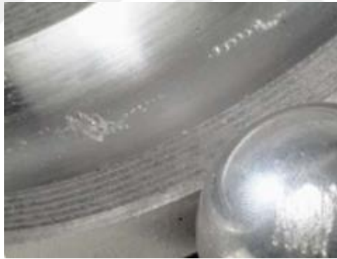
Şekil 2.23. Aşırı akım erozyonu sunucu dış bilezik ve bilyede oluşan kraterler
