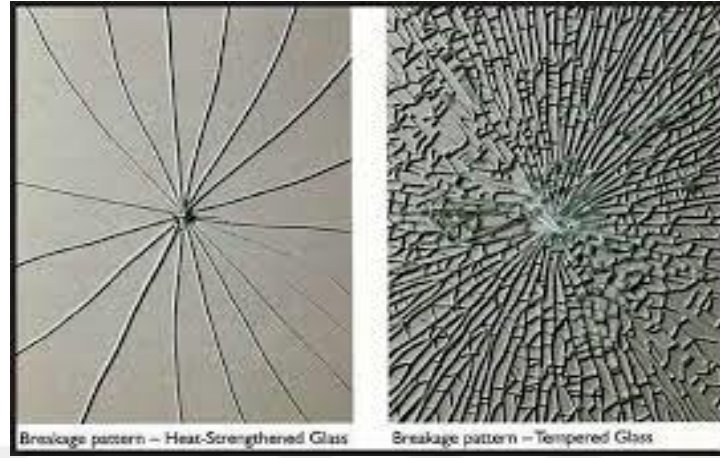
Şekil 2.100. Normal cam ile temperlenmiş cam arasındaki fark (Yorsan, 2015)
