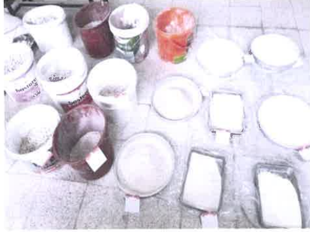
Şekil 3.9. Eleklerin üstünde kalan malzemelerin tane çaplarına göre ayrılması
