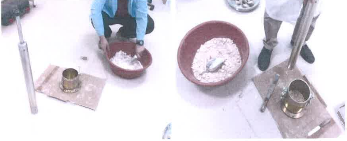
Şekil 3.28. Modifiye Proktor deneyinin yapılışı
