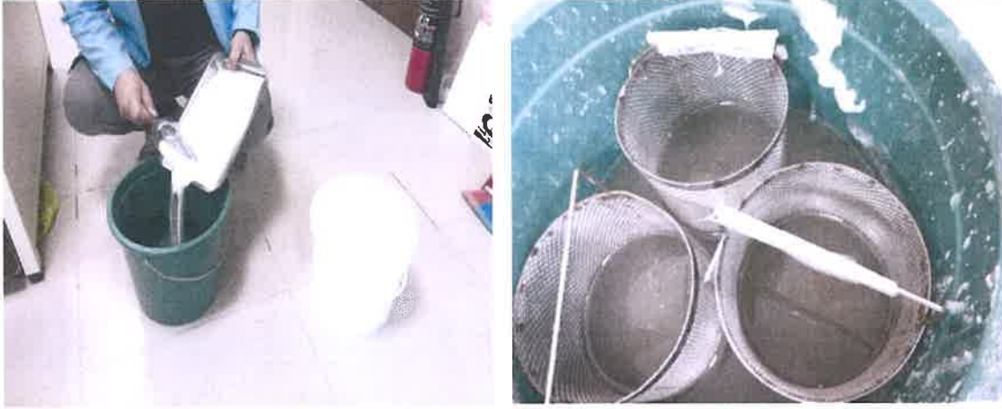
Şekil 3.10. Hava tesirlerine karşı dayanıklılık deneyi yapılışı
