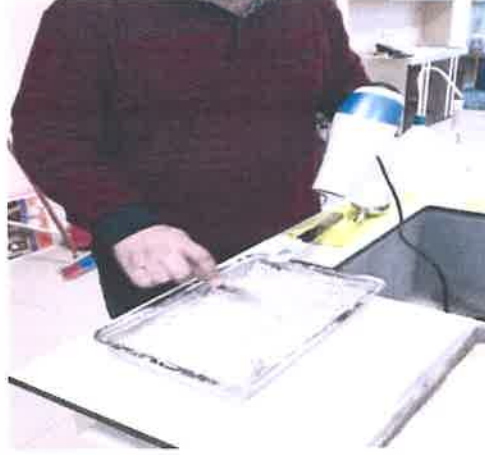
Şekil 3.14. İnce agrega deneyi için numunelerin kuru yüzey doymun haline getirilmesi
