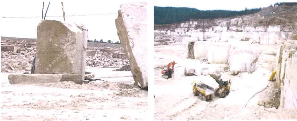
Őekil 1.3. Mermerin blok Őeklinde ayrılması iřlemi
