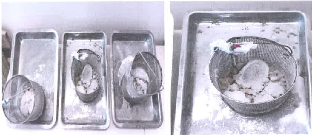
Şekil 3.11. Sodyum Sülfat ( \text{Na}_2\text{SO}_4 ) çözeltisinden çıkarılmış deney numuneleri
