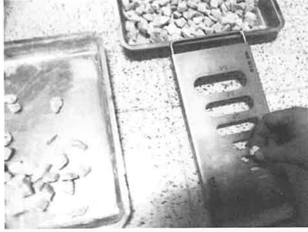
Şekil 3.22. Yassılık indeksi şablonu yardımıyla yassı agregaların tespit edilmesi
