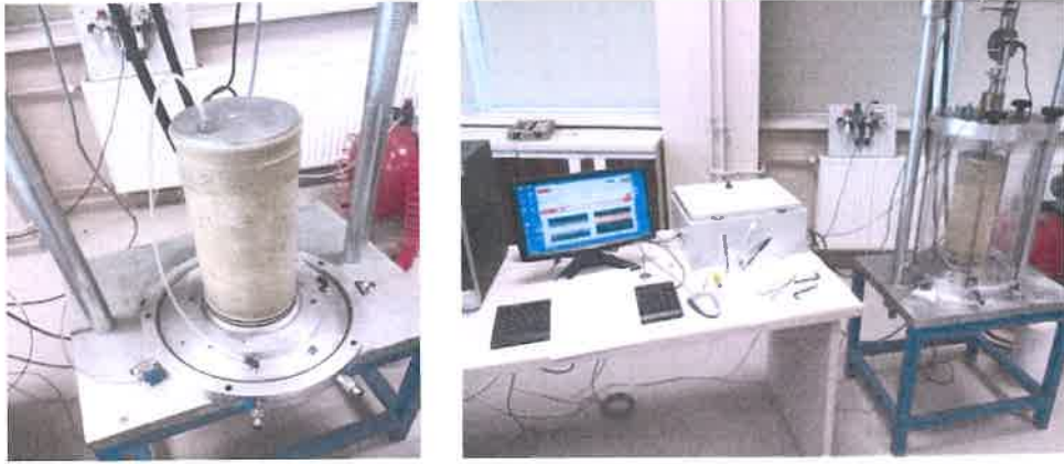
Şekil 3.37. Deney numunelerinin üç eksenli cihazına yerleştirilmesi
