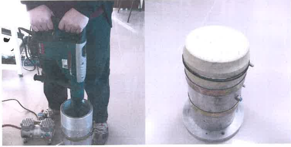
Şekil 3.36. Deney numunelerinin titreşimli kompaksiyonla sıkıştırılması
