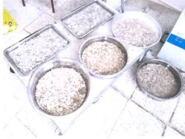
Şekil 3.17. Kaba agrega numularının suda bekletilmesi
