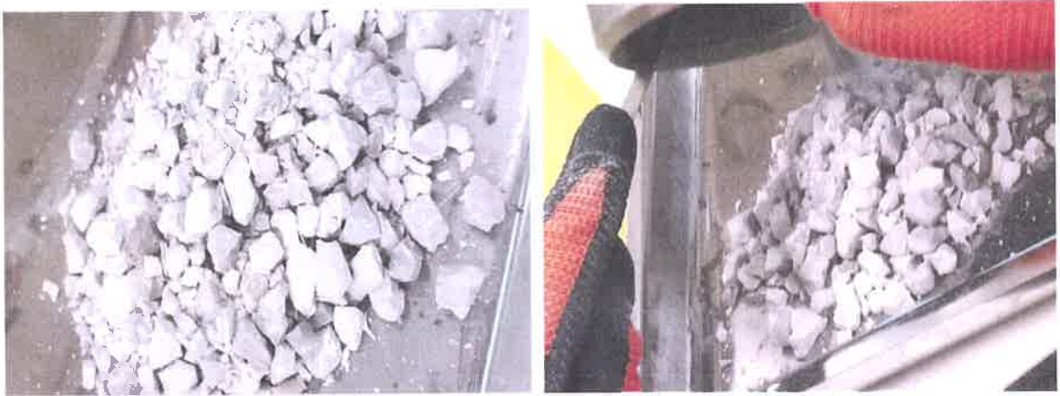
Şekil 3.21. Deney sonrası darbelenme cihazından çıkarılan malzemeler
