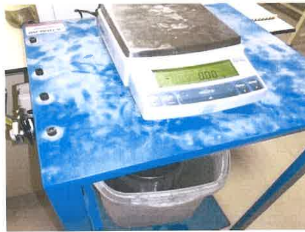
Şekil 3.18. Arşimed terazisi ile su içinde tartım işlemi
