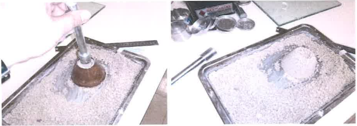
Şekil 3.15. Abrahams hunisi ile kuru yüzey suya doymun halin kontrol edilmesi
