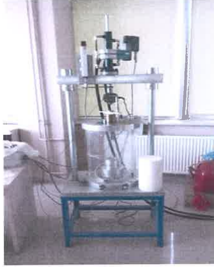
Şekil 3.33. Dinamik üç eksenli deneyi cihazı (Yılmaz vd, 2008)
