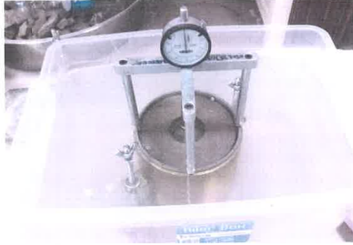
Şekil 3.32. Yaş CBR deney numunesinin suda bekletilmesi
