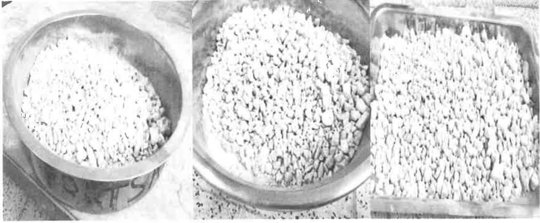
Şekil 3.25. Los Angeles deneyi sonrası numunelerin görünümü
