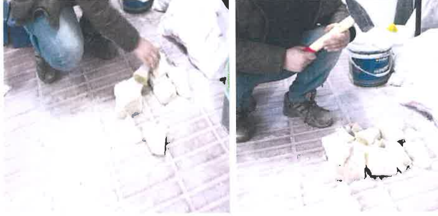
Şekil 3.3. Numunelerin konkasör haznesine girebilmesi için çekiçle kırılması
