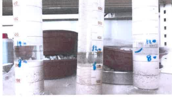
Şekil 3.26. Organik madde tespiti deneyi
