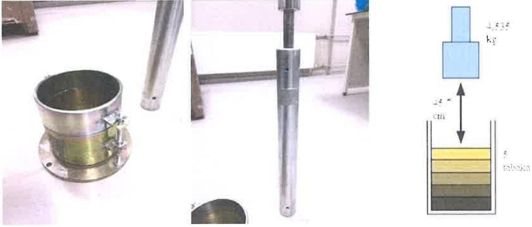
Şekil 3.27. Modifiye Proktor deneyinde kullanılan malzemeler
