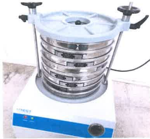
Şekil 3.8. Deney numunelerinin elek sarsma tablasında elenmesi
