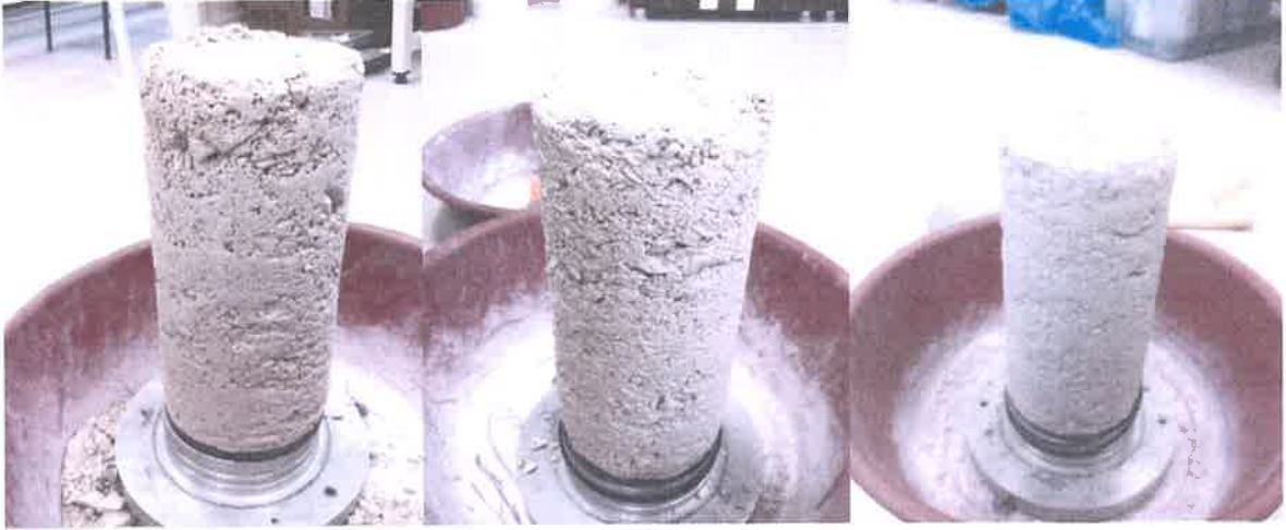
Şekil 3.38. Deneilerin sonunda üç eksenli cihazından çıkarılan numuneler
