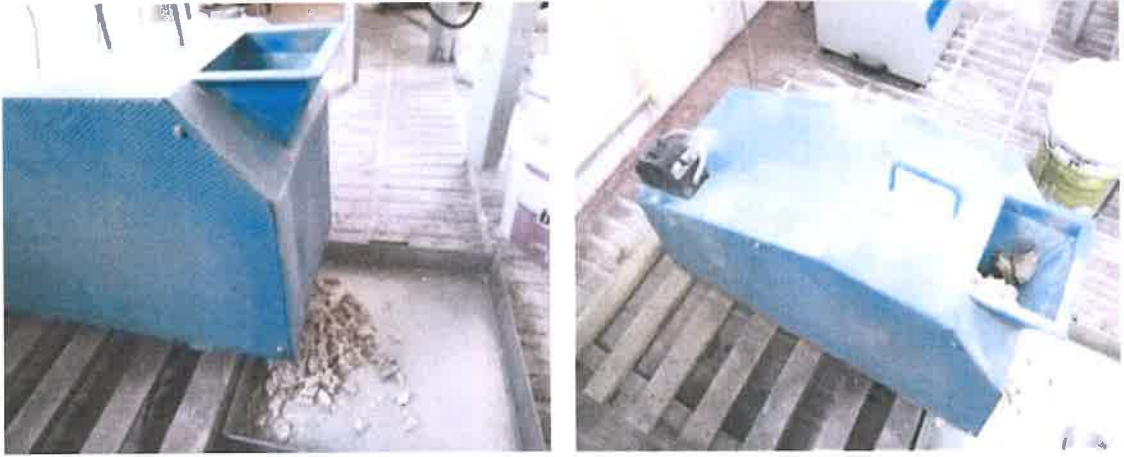
Şekil 3.4. Numunelerin konkasör yardımıyla kırılması işlemi
