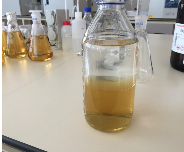
Şekil 3.6. Etil asetat ilavesi ile örneklerde gerçekleşen faz ayrımı
