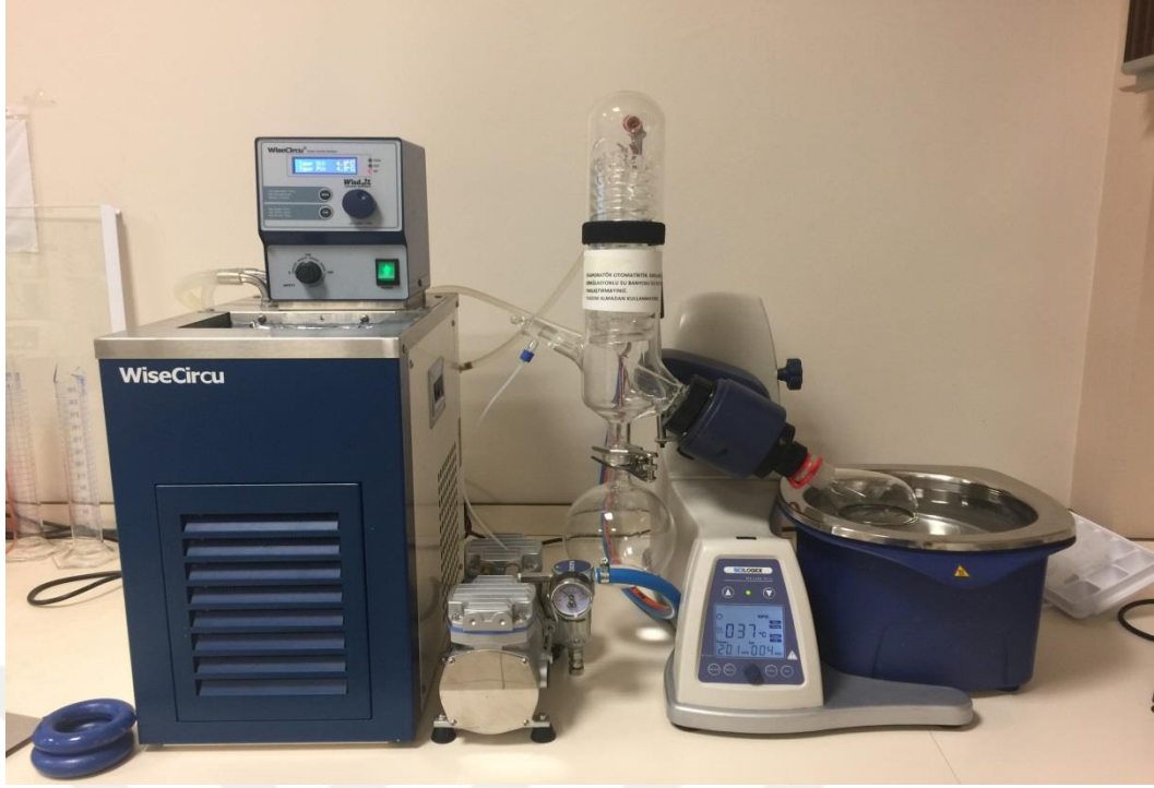
Şekil 3.7. Rotary evaporatör ile organik fazın uzaklaştırılması
