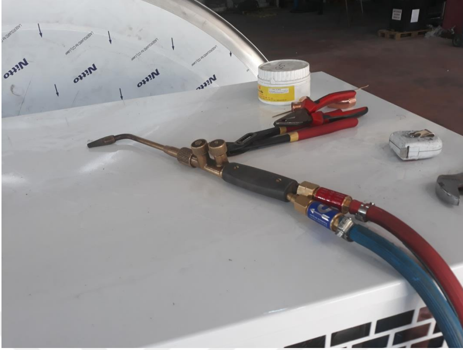
Şekil 2.14. İşletmede kullanılan oksigaz kaynağı şaloması
