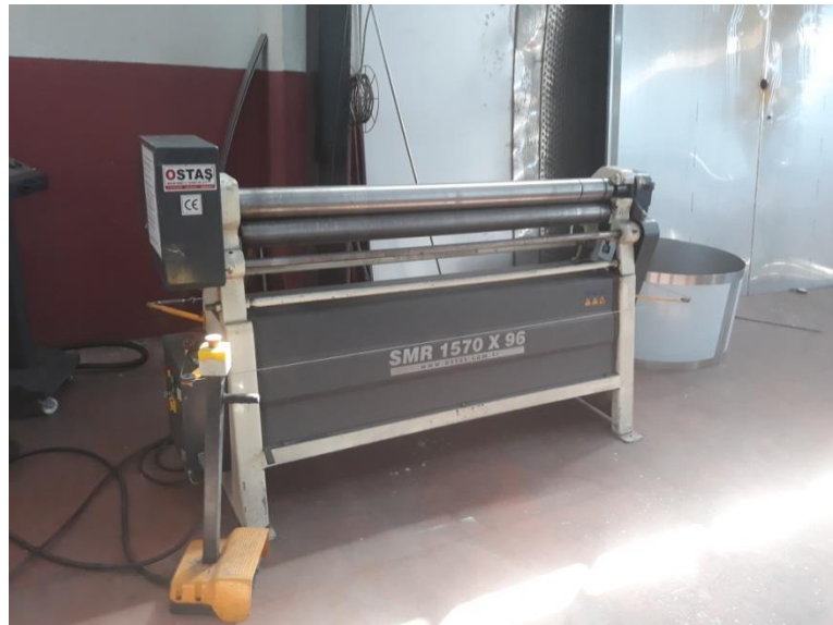
Şekil 2.30. İşletmede kullanılan silindir bükme makinası
