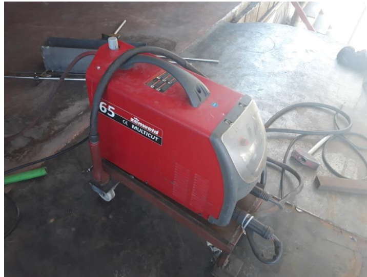
Şekil 2.21. İşletmede kullanılan çanta tipi plazma kesim makinesi
