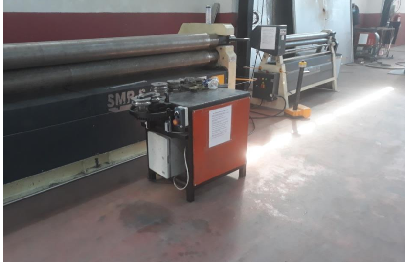
Şekil 2.31. İşletmede kullanılan boru bükme makinası
