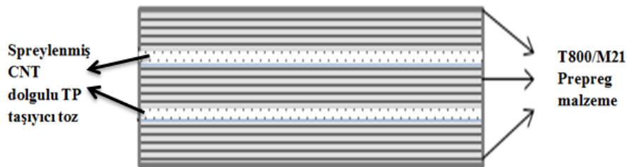
Şekil 4.2 Üretilen CNT takviyeli kompozit malzemenin şematik görüntüsü.
