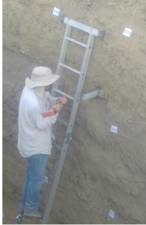
Şekil 5. 16: OSL/TL analizi için çelik ve plastik tüpler kullanılarak örnek alma.
