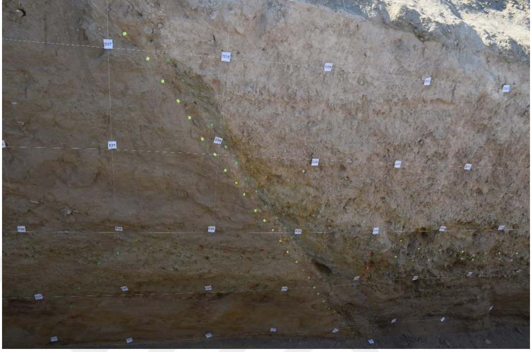
Şekil 5. 12: T1 hendeği batı duvarının yakından görünümü. (sol üstten sağ alta doğru giden sarı-yeşil renkli bayrakla işaretlenmiş zon ana fay hattıdır).
