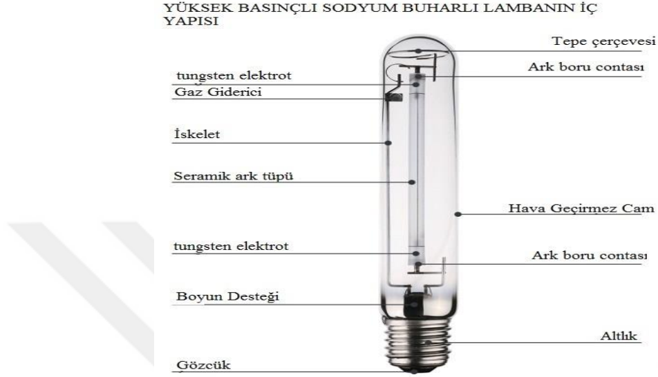
Şekil 1.1.3.1. Yüksek Basınçlı Sodyum Buharlı Deşarj Lamba Yapısı (Anonim, 2017h)
