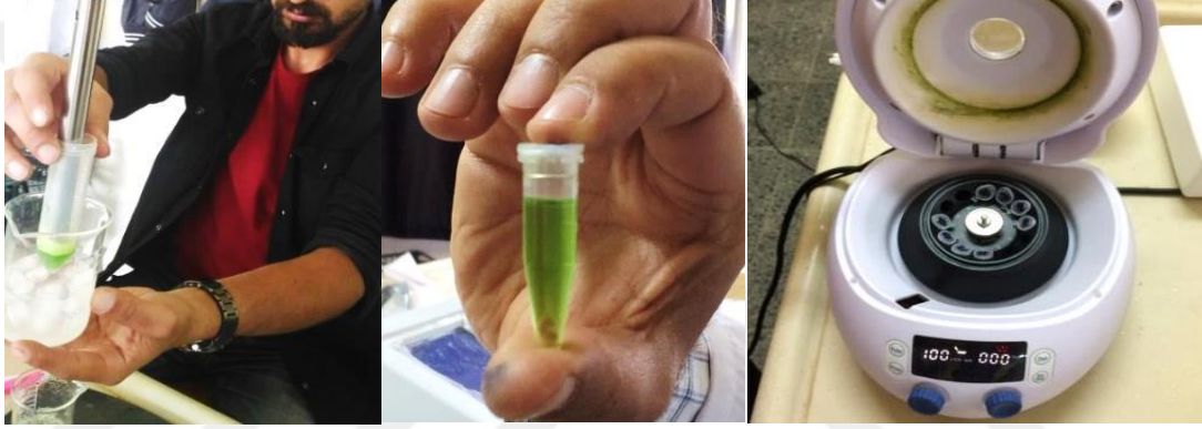
Şekil 26. Yaprak örneklerinin asetonda parçalanması ve santrifüj edilmesi
