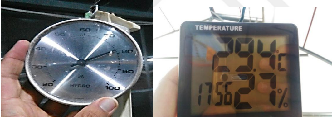
Şekil 4. Denemede ortam koşullarını ölçmek amacıyla kullanılan hidrometre ve dijital termometre
