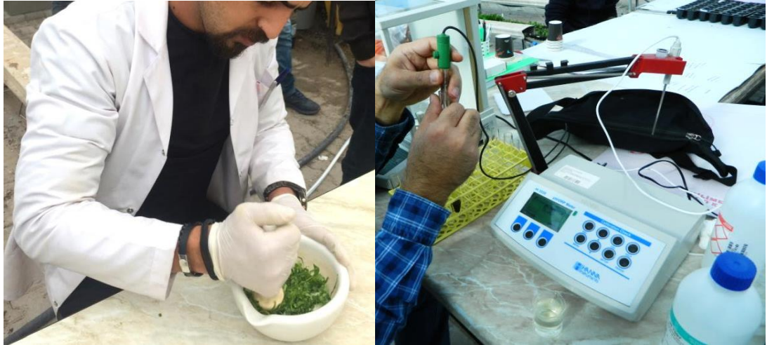
Şekil 25. Fide yapraklarının ezilmesi ve Yaprak suyunun pH'nın belirlenmesi
