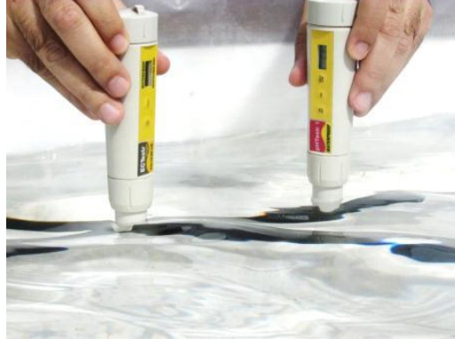
Şekil 15. Besin solüsyonunun el tipi EC ve pH metre ile kontrol edilmesi
