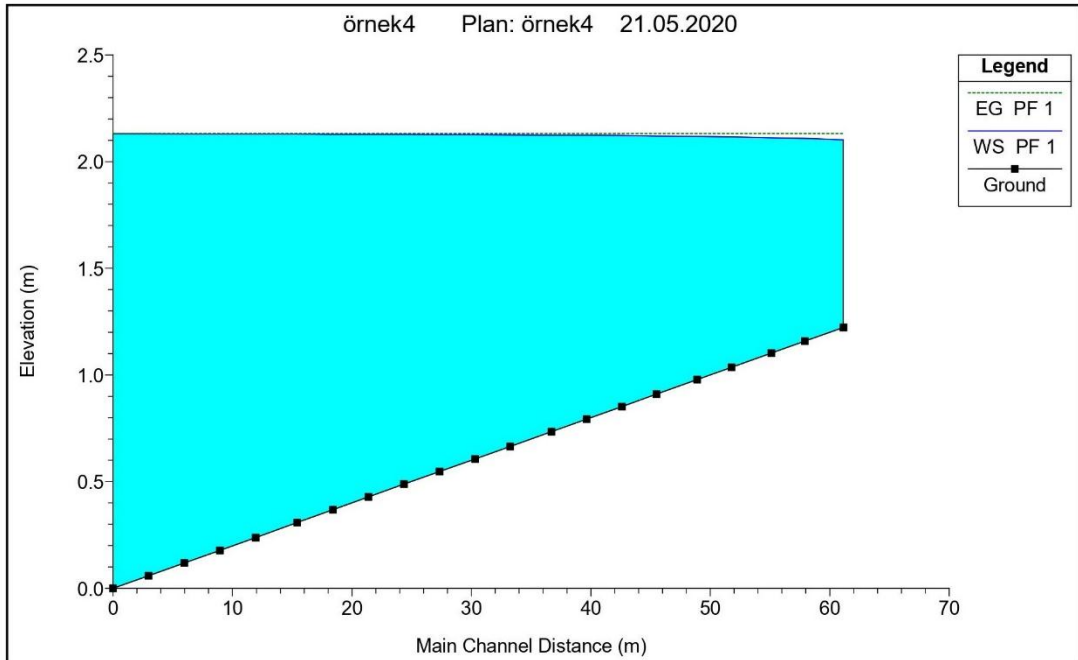
Şekil 4.16: Uygulama 4 için HEC-RAS programından alınan su yüzü profili
