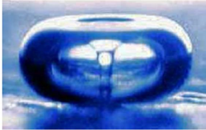
Şekil 1.5: Kavitasyon baloncuğunun oluşumu (Web_4)
