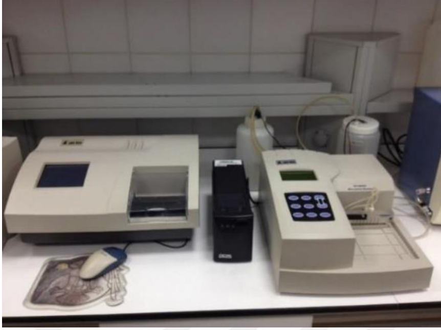
Şekil 3.7. Analizde kullanılan Rayto® marka mikro plaka okuyucusu ve yıkayıcısı
