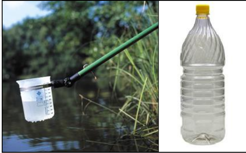
Şekil 3.2: Su örneklerinin alınmasında kullanılan aparat ve su örneklerinin konulduğu kap.
