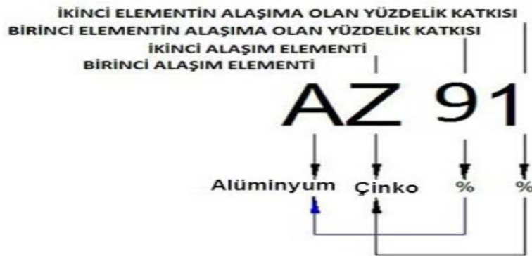
Şekil 3,3 Magnezyum Alaşımlarında Kodlama Yöntemi (25)
