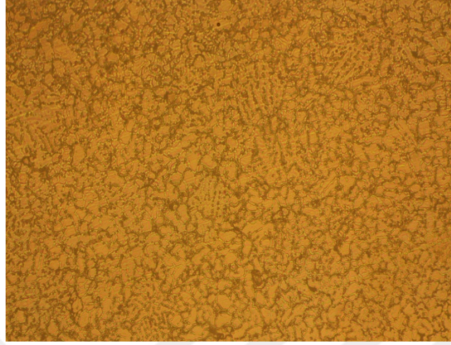
Şekil 5.5. 2 Numaralı Basınçlı Döküm Yöntemi ile Elde Edilen Numunenin Optik Mikroskop Görüntüsü (%A-Mg-Mg 17 Al 12 : 60-40)
