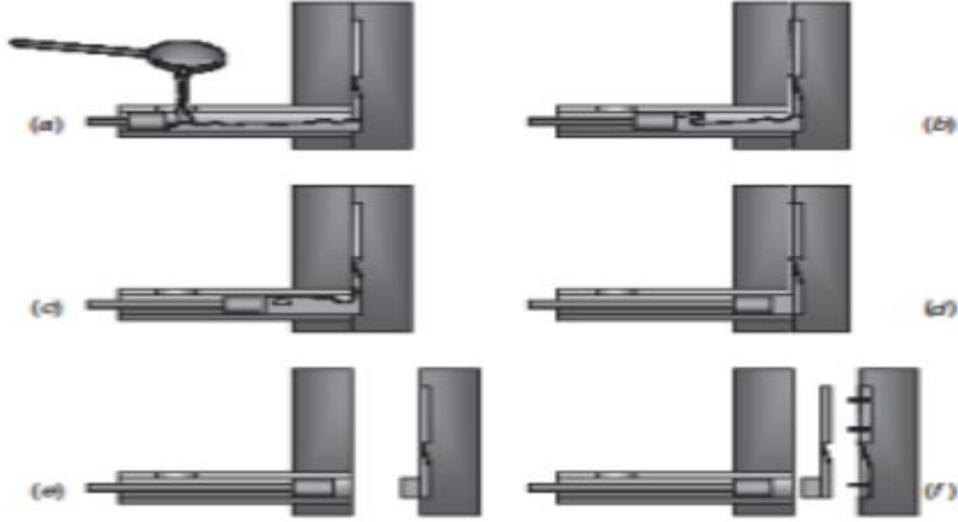
Şekil 3.7 Soğuk Kamaralı Makinede İşlem Döngüsü (12)
