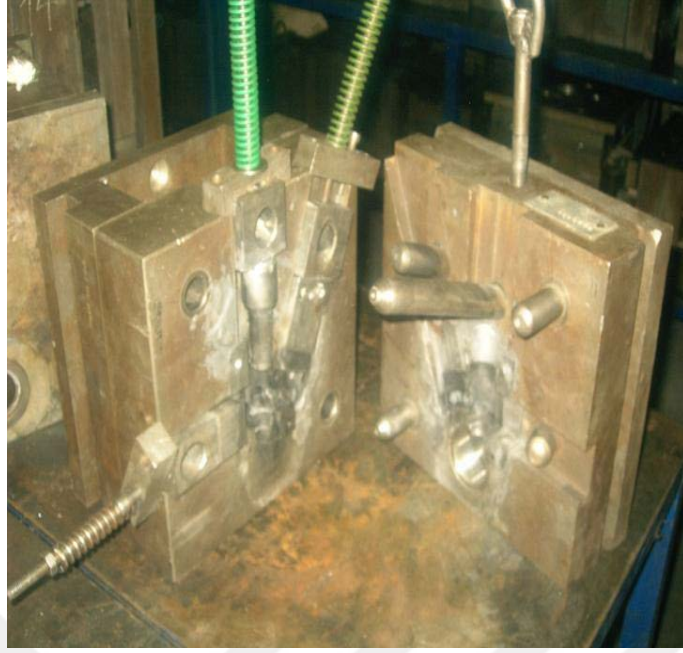
Şekil 3,9. Basınçlı Döküm Kalıbı (5)
