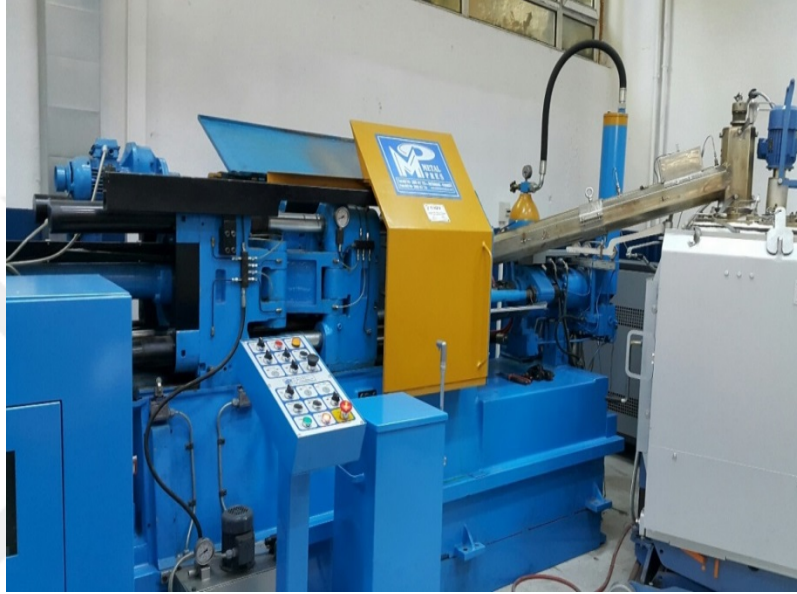
Şekil 4,1. Metal Pres MP100 Basınçlı Döküm Makinesi
