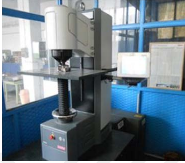
Şekil 4.9. Emco Test Dur Vision 30, Mepro Sertlik Ölçme Cihazı
