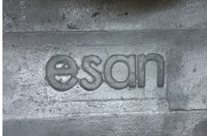
Şekil 3,2 Külçe Haldeki AZ91 Magnezyum Alaşımı
