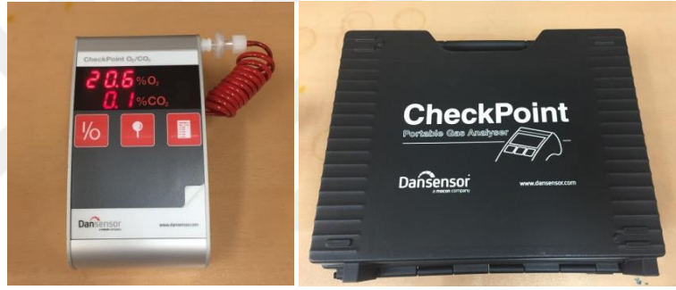
Şekil 2.2: Paket içi gaz atmosferinin belirlenmesinde kullanılan cihaz
