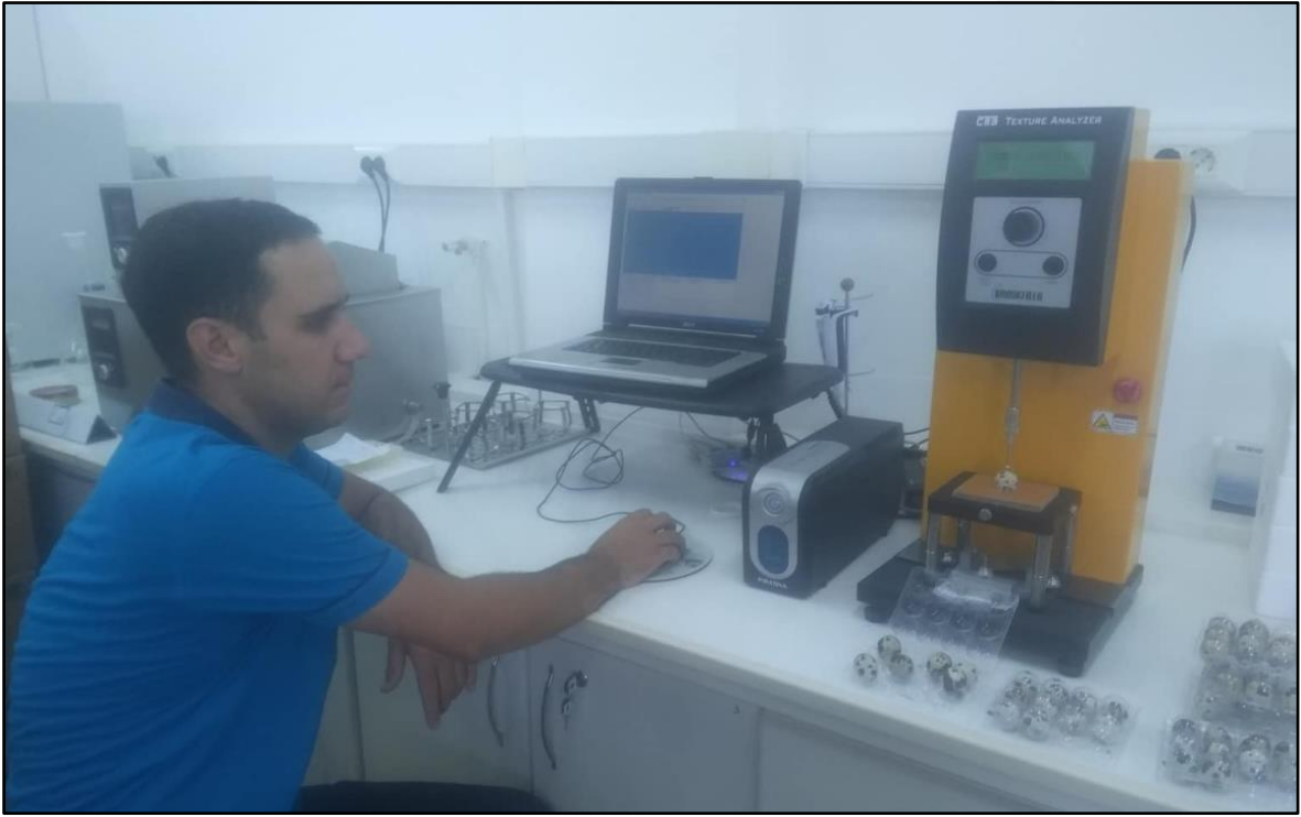
Şekil 3.2. Kabuk kırılma direnci ölçme makinesi
