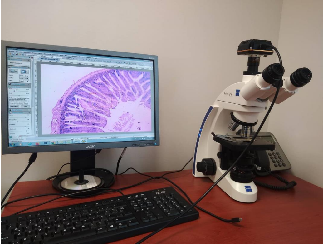
Resim 7. Zeiss Primostar Mikroskop ile ileum örneklerinin görüntülenmesi ve ölçülmesi (10x büyütmede gerçekleştirilmiştir).
