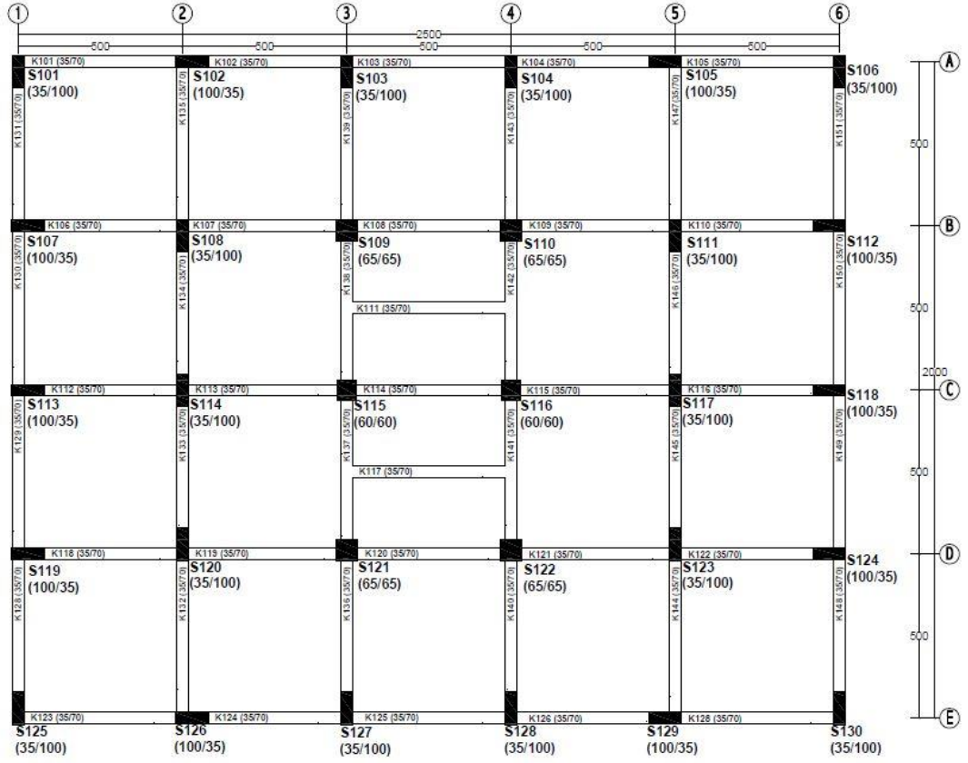
Şekil 3.1: Modellenen binalara ait kalıp planı
