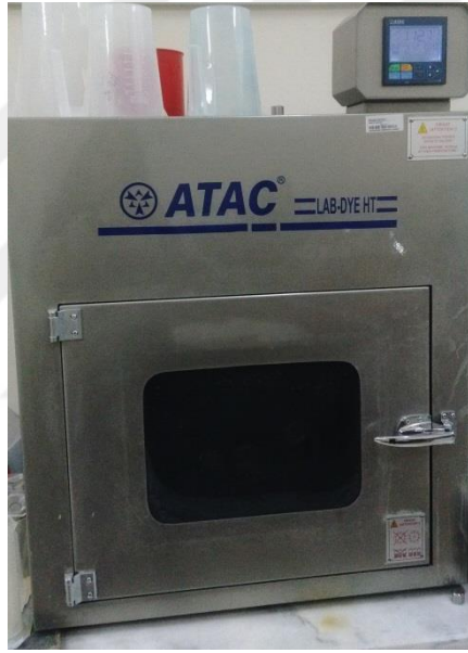
Şekil 7.1: ATAÇ LAB DYE HT laboratuvar tipi boyama makinesi
