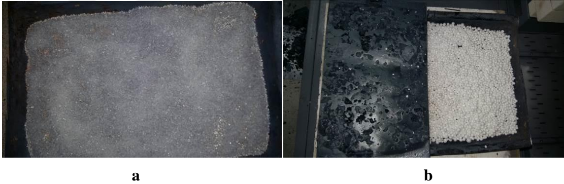
Resim 4.1 Silika jel görüntüleri; (a) Genleştirme işlemi öncesi; (b) Genleştirme sonrası
