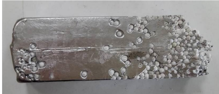
Resim 5.1 Üniform dağılıma sahip olmayan N1 kodlu köpük malzeme.
