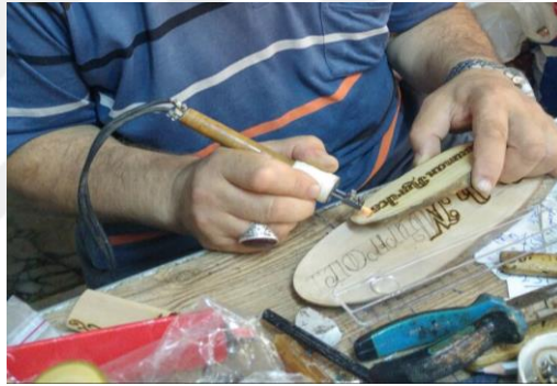
Şekil: 4-114 İsimliğe yakı kalemle isim yazılması, Çekiciler Çarşısı/Amasra (Ayrıksa, 2018)
