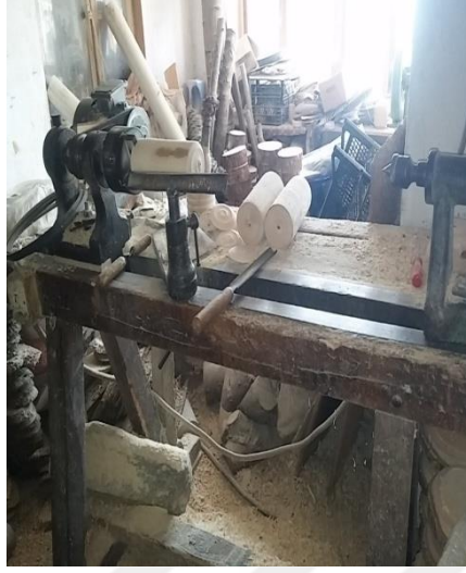
Şekil: 4-31 Ağaçların kabuklarını soyup silindirik şekil veren torna Ahatlar Köyü/Amasra (Ayrıksa, 2018)
