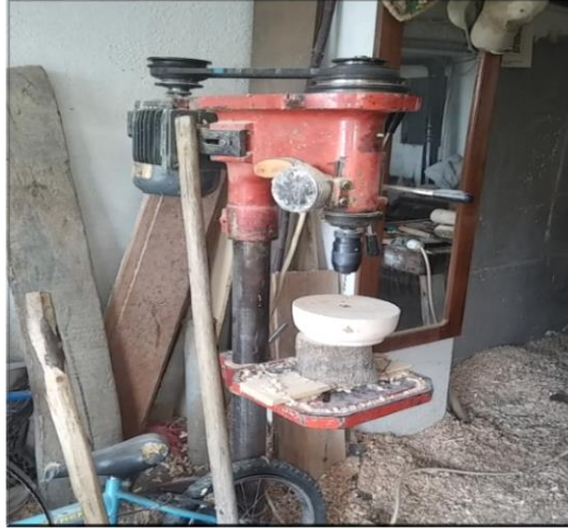
Şekil: 4-30 Sütunlu matkap tezgâhı ve delme işlemi, Ahatlar Köyü/Amasra (Ayrıksa, 2018)
