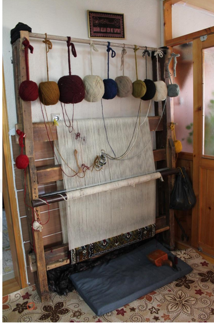
Şekil 4.17. Yahyalıda Halı Dokumada Kullanılan Ahşap Germe Tezgâh ( Kaplanoğlu, 2018)
