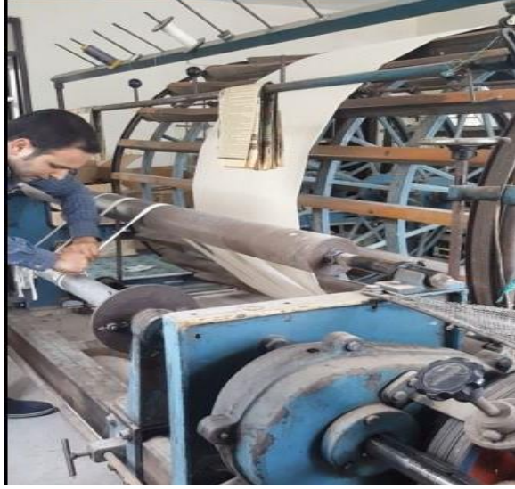
Şekil 4.116. Çözgü ucunu büküm Makinesine Bağlama (Azime Güven Arşivi, Alanya 2019).
