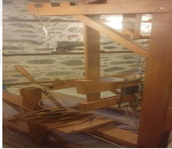
Şekil 4.39. Tezgâhı gerginleştirmeye yarayan el ağacının takılması (Azime Güven Arşivi, Alanya, 2019).
