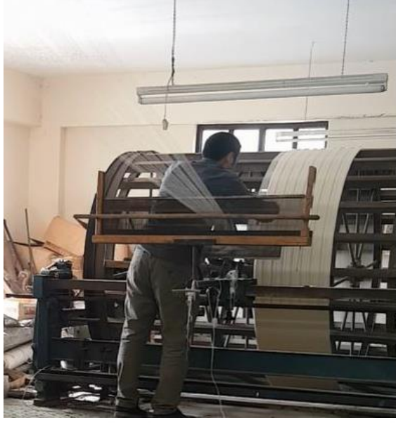
Şekil 4.114. Çözgüde ipliklerin karışmasını önleyen ağızlık kısmının oluşması (Azime Güven Arşivi, Alanya 2019).
