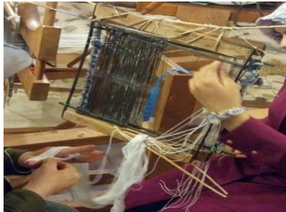
Şekil 4.35. İpek iplik çözüleri gücü tellerinden geçirilmesi (Azime Güven Arşivi, Alanya, 2019).
