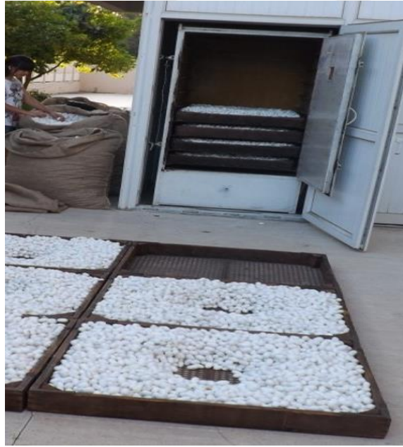
Şekil 4.155. Koza fırınında kozanın boğulup kurutulması (Azime Güven Arşivi, Alanya 2019).
