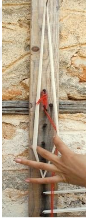
Şekil 4.32. Ağızlığın karışmaması için Kırmızı İplik ile Bağlanması (Azime Güven Arşivi, Alanya, 2019).
