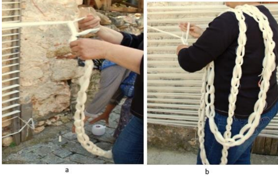
Şekil 4.32. a-b. Uzun çile halinde olan çözü ipliklerinin birbirlerine dolanmaması için çözü aparatından toplanırken yapılan zincir (Azime Güven Arşivi, Alanya, 2019).
