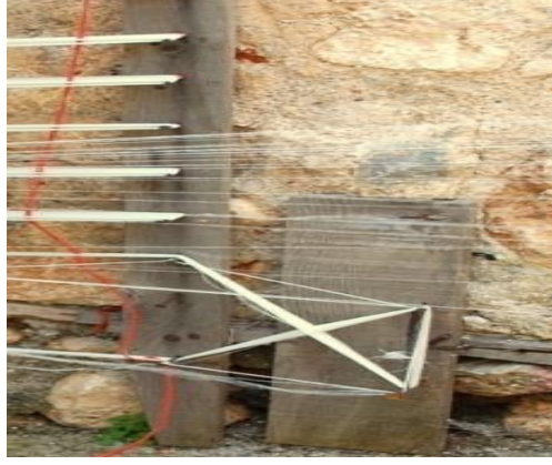
Şekil 4.31. Çözüde iplerin karışmasını önleyen ağızlık kısmının ayarlanması (Azime Güven Arşivi, Alanya, 2019).
