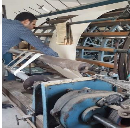
Şekil 4.117. Diğer yarısından kalan çözgü ucunu bağama ve makine sıklığını ayarlama (Azime Güven Arşivi, Alanya 2019).
