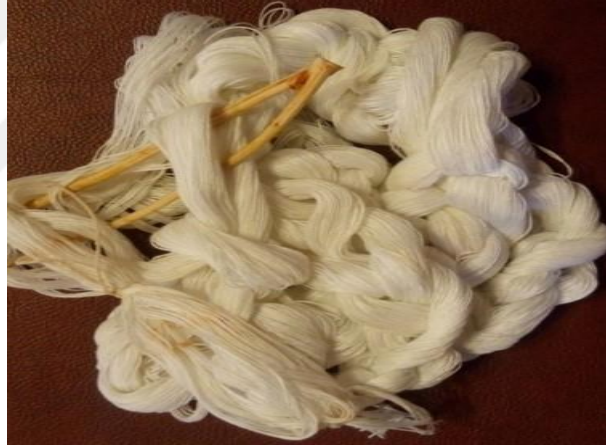
Şekil 4.33. Çözü ağacından çıkarılmış çile halindeki çözü ipliği (Azime Güven Arşivi, Alanya, 2019).
