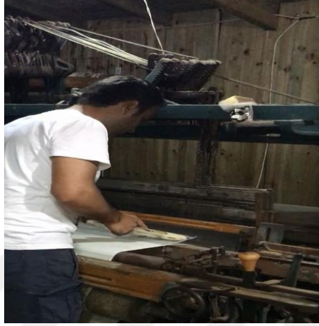
Şekil 4.124. Mekiği tezgâha bağlayarak ipek kumaş dokumasının hazırlanması (Azime Güven Arşivi, Alanya 2019).
