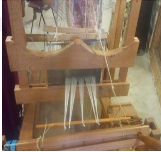
Şekil 4.37. gücü ve tarağı, tezgâha bağlanması (Azime Güven Arşivi, Alanya, 2019).
