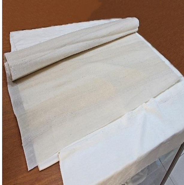
Şekil 4.129. Altta pişmemiş ipek iplik ile dokunmuş (Yumuşak) kumaş, üstte pişmiş ipek iplik ile dokunmuş (hafif sert) kumaş (Azime Güven Arşivi, Alanya 2019).
