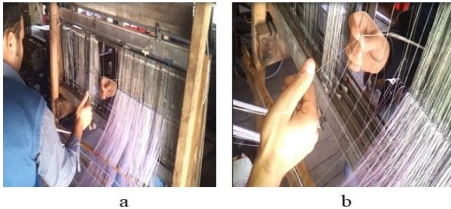
Şekil 4.121. a. b. İpek iplik çözümleri gücü tellerinden geçirilmesi (Azime Güven Arşivi, Alanya 2019).
