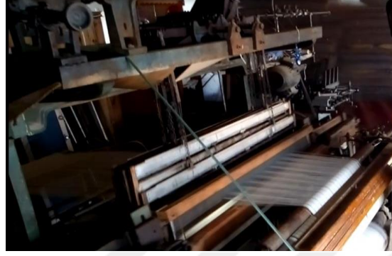
Şekil 4.122. Dokuma tezgâhının ön silindirine küçük guruplar hâlinde bağlama (Azime Güven Arşivi, Alanya 2019).
