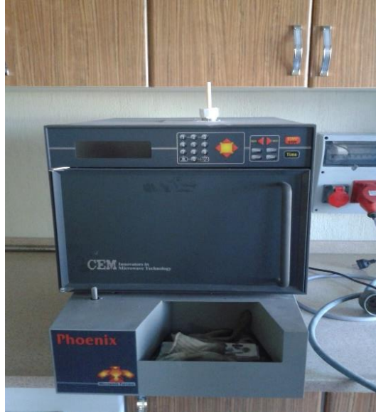
Resim 3.3 Borlama işleminde kullanılan Mikrodalga fırının fotoğrafı.
