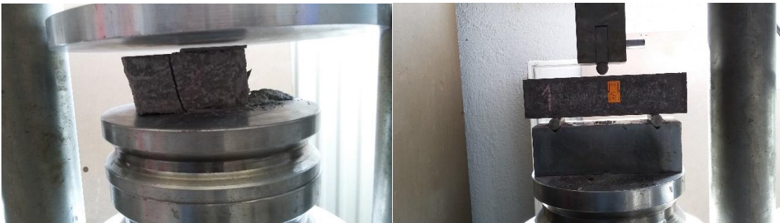
Resim 3.8 Numunelerin basınç deneyi (solda) ve eğilme deneyi (sağda).
