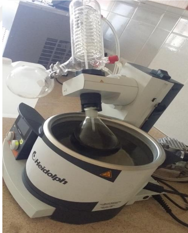
Resim 3.2 Rotary evaparatörde alkolün uçurulması.
