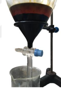
Resim 3.11 Ayırma hunisinde pirolitik yakıt ve suyu ayırma işlemi.
