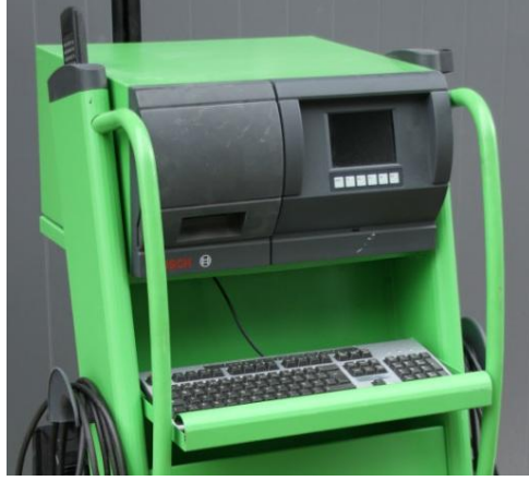
Resim 3.7 Bosch BEA 350 egzoz emisyonu ölçüm cihazı.
