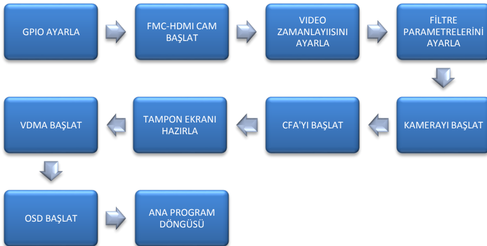
Şekil 4.4 Sistem Yazılımı Akış Şeması.
