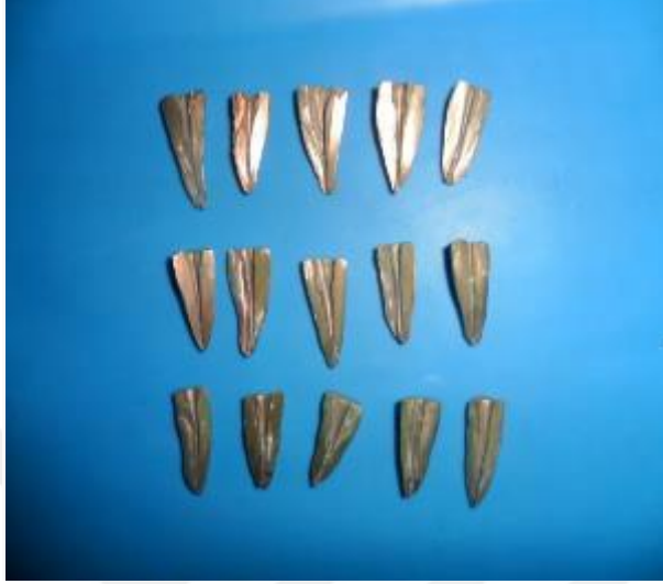
Resim-2.5 Altın kaplanmış örnekler
