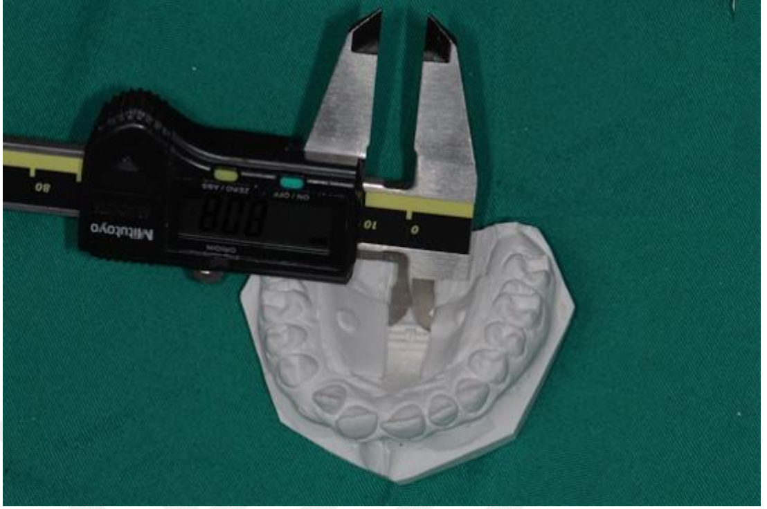
Şekil 2.4. Meydana gelen genişletme miktarlarının model üzerinde Dijital Kumpas ile ölçülmesi.
