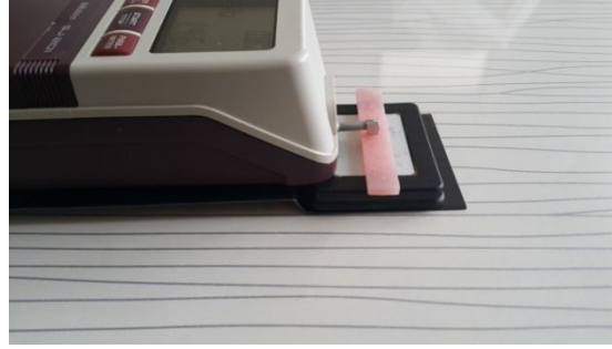
Şekil 2.16. Bir örneğe ait yüzey pürüzlülüğü ölçümünün yapılması.
