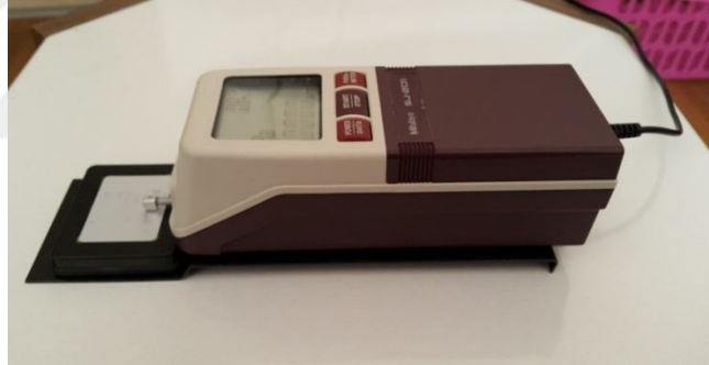
Şekil 2.15. Yüzey pürüzlülüğü ölçümlerinin yapıldığı profilometre.
