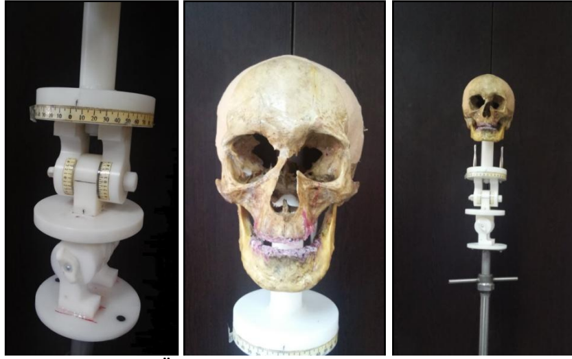
Şekil 2.2 Üç ayaklı konumlandırıcı ve insan kuru kafa modeli gösteren fotoğraf
