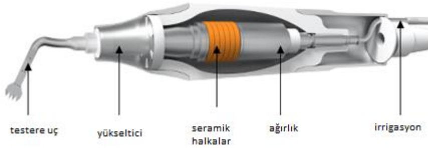
Şekil 1.8. Piezoelektrik cihazının el parçası.
