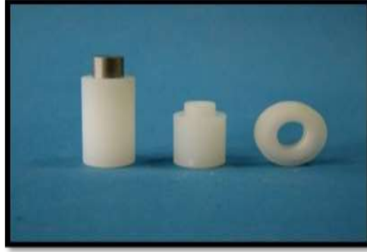
Şekil 3.10. Örnekleri hazırlamak için kullanılan tefflon halka.
