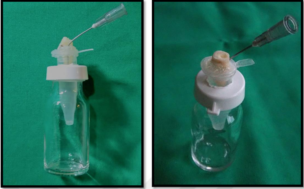
Şekil 2.2. Taşan debrisin toplanması için kurulan deney düzeneği.
